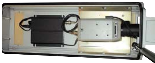
Рис. 5.2а Пример установки маленького одноканального видеокодера рядом с аналоговой камерой в кожухе.
