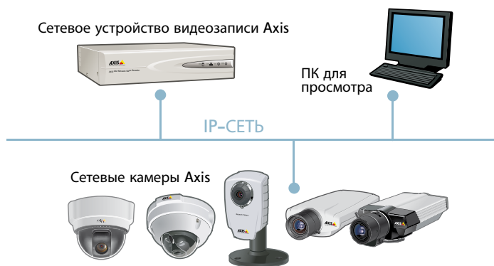
Рис. 11.1b Система сетевого охранного видеонаблюдения, использующая сетевое устройство видеозаписи.
