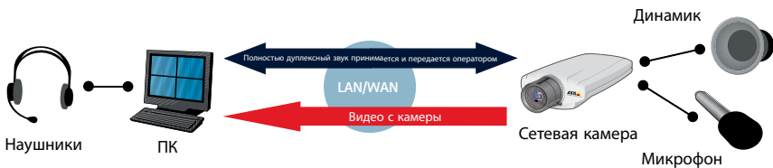
Рис. 8.3d В режиме полного дуплекса звук передается к оператору и от него одновременно. Этот режим напоминает телефонный разговор. Полный дуплексный режим требует использования звуковой карты с поддержкой полного дуплексного звука.
