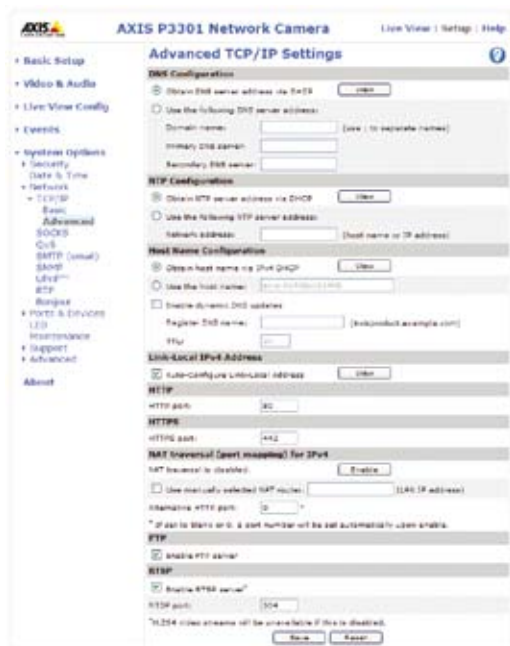
Рис. 9.2b Устройство сетевого видео Axis позволяет выполнить переадресацию портов с помощью NAT traversal.
