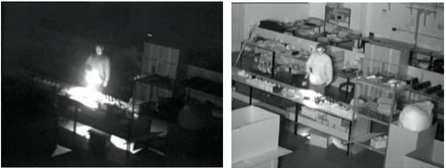
Рис. 2.3с Слева – изображение без источника ИК-излучения; справа – изображение с применением источника ИК-излучения.
