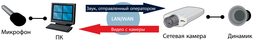
Рис. 8.3б В данном примере режима симплекс звук передается оператором на камеру. Его можно использовать, например, для передачи инструкций человеку, снимаемому камерой, или чтобы отпугнуть потенциального вора от парковки.
