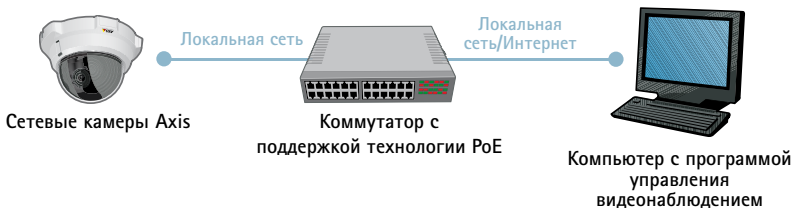
Рис. 2.1а Сетевая камера подключается непосредственно к сети.
