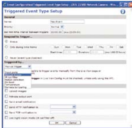
Рис. 11.3е Установка запуска события с помощью веб-интерфейса системы сетевого видеонаблюдения Axis.
